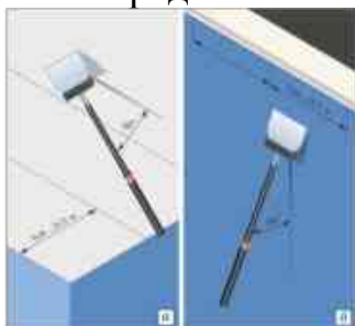
Очистка скребком потолка (а) и стен (б)
